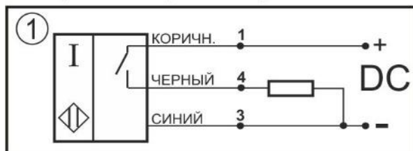
Схема соединения Нормально-разомкнутый контакт
